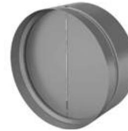
Обратный клапан SKO предназначен для предотвращения перетекания воздуха через ответвления к отключенным вентиляторам (от отключенных вентиляторов). Корпус обратного клапана изготовлен из оцинкованного стального листа. Лопатки изготовлены из листового алюминия. Автоматическое пере-
