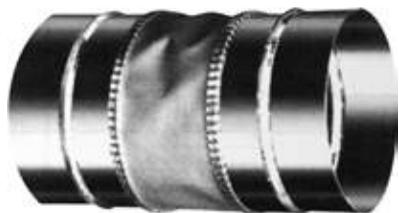
Гибкие вставки SG выполняют функцию виброгашения и предназначены для поглощения механических колебаний и предотвращения распространения вибрационного шума отдельных элементов работающего оборудования (вентиляторов) по воздуховодам на всю вентиляционную систему, а также для частичной компенсации температурной деформации
