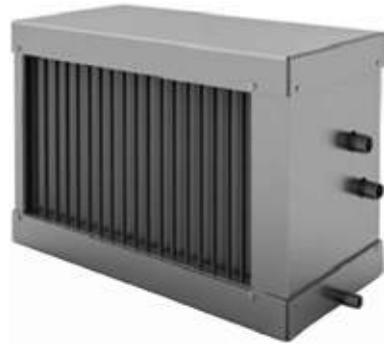
Водяные охладители SPC-W предназначены для охлаждения воздуха в системах вентиляции и кондиционирования. Эффективный медно-алюминиевый пластинчатый теплообменник в трёхрядном исполнении. Теплообменник изготовлен из алюминиевых ламелей толщиной 0,2 мм с шагом 2,5 мм и проходящих через них медных трубок диаметром 9,52 мм. Шахматное расположение трубок. Хладоноситель: вода или незамерзающие смеси (максимально допустимое давление
