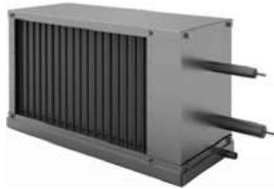
Фреоновые охладители SPC-F предназначены для охлаждения воздуха в системах вентиляции и кондиционирования. Эффективный медно-алюминиевый пластинчатый теплообменник изготовлен в трёхрядном исполнении. Теплообменник изготовлен из алюминиевых ламелей толщиной 0,2 мм с шагом 2,5 мм и проходящих через них медных трубок диаметром 9,52 мм. Шахматное расположение трубок. Каплеуловитель расположен за теплообменником по ходу воздуха и служит для
