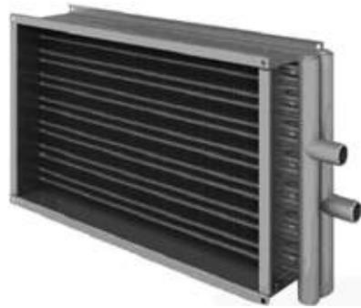
Водяные воздунонагреватели типа SPH-W предназначены для нагрева воздуха и устанавливаются в воздуховодах систем вентиляции и кондиционирования воздуха промышленных и общественных зданий. Теплообменник изготовлен из алюминиевых пластин и проходящих через них медных трубок диаметром 9,52 мм. Шахматное расположение трубок. Корпус из оцинкованного стального листа. Специальные резьбовые патрубки теплообменников для удобства слива воды и обезвоздушивания теплообменника.
